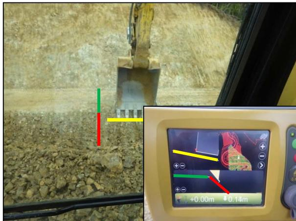
写真3 バケット位置のガイダンス状況
