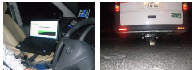
写真-4 車載型FWDの外観及び車内
