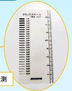
コンクリートやタイルのひび割れの状態や幅を計測するためのクラック幅が記された定規です。
