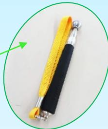
タイルがコンクリートの躯体と密着しているか、モルタルが剥離していないかなど、検査できます。打診による反響音の違いで、モルタルやタイルが浮いている事が分かります。
