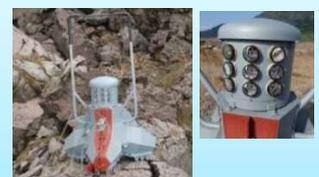
溶岩ドームに設置している光波プリズム
