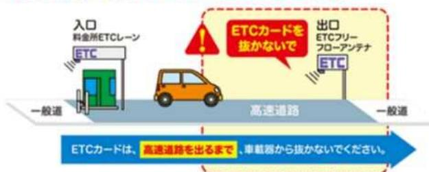
※ETCフリーフローアンテナとは、料金所のない入口または出口に設置されたETCマークの看板のあるETC無線通信を行うアンテナです。
