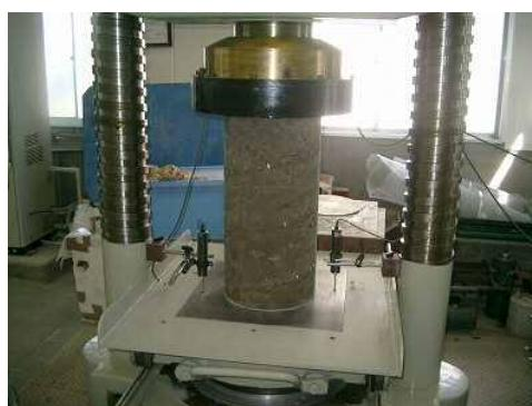
▲大型供試体試験 強度試験
