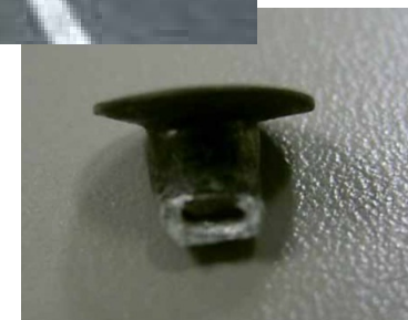
破断したブラインドリベット
