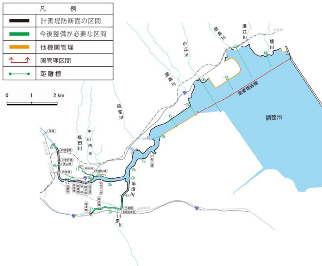
図2-1-1 堤防整備状況(国管理区間:平成25年度末時点)
