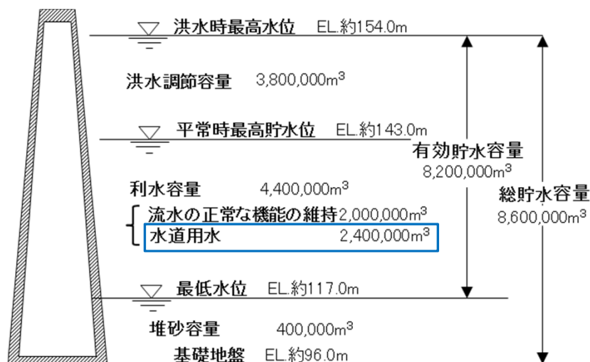
図 本明川ダム容量配分 (河川整備計画時)
