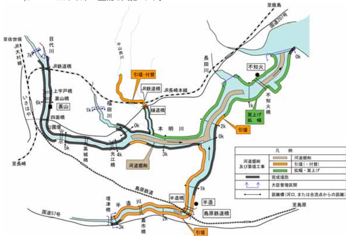
図4 - 2 - 3 河道掘削及び築堤工事の場所
