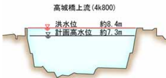
図2-1-3 市街地区間における洪水疎通能力不足 (昭和32年7月洪水流下時)
