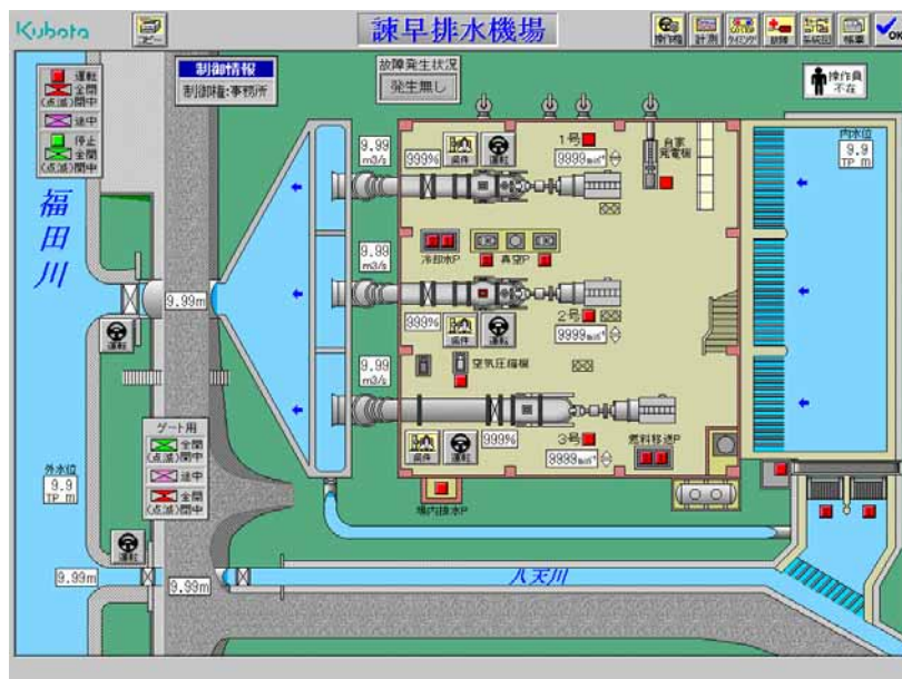
図4 - 3 - 6 ポンプ場遠隔操作(パソコン画面)
