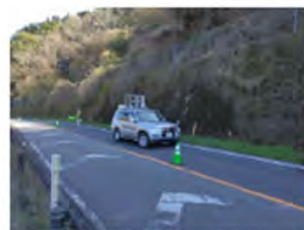
MMS※1を活用した 斜面・のり面点検
