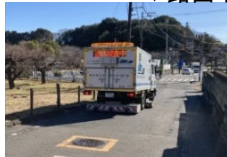
(空洞探査車による調査)
