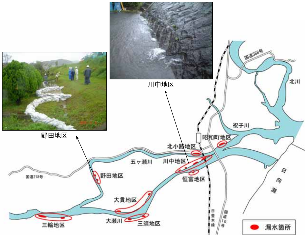
図 2-1-4 平成 17 年 9 月洪水時の漏水の状況
