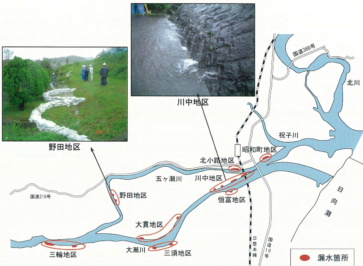
図 2-1-5 平成 17 年 9 月洪水時の漏水の状況
