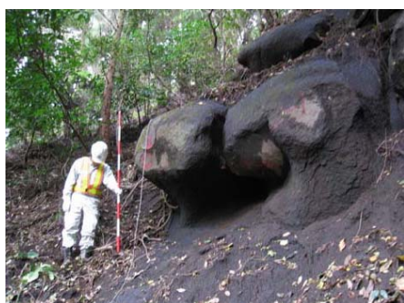
【斜面の点検（転落）】
