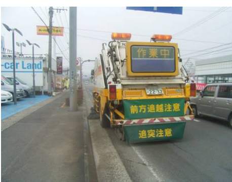
【路面清掃車による清掃】
