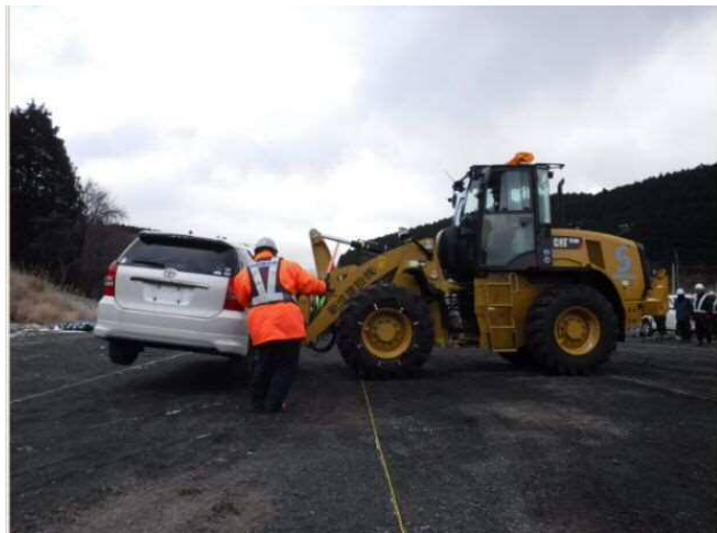
ホイルローダーによる放置車両移動訓練
