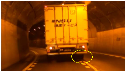
▲カーブ区間で車線逸脱
