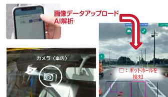
スマートフォンやドライブレコーダー による舗装損傷検知
