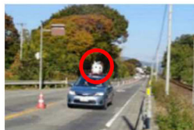
車載装置による路面性状測定
