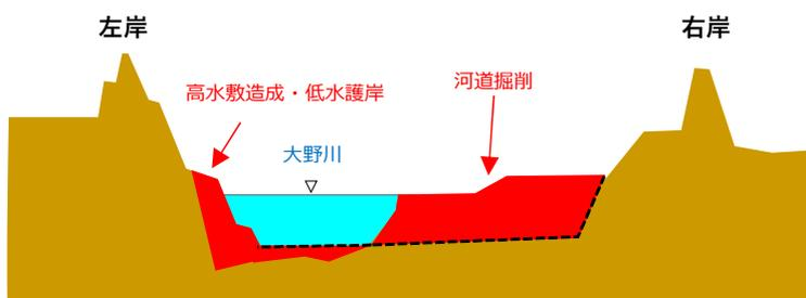
大津留地区においては、平成29年9月の台風第18号洪水等による河岸侵食の状況や昭和18年の堤防決壊の実績を踏まえ、粘り強い河川堤防として堤防強化を実施します。
