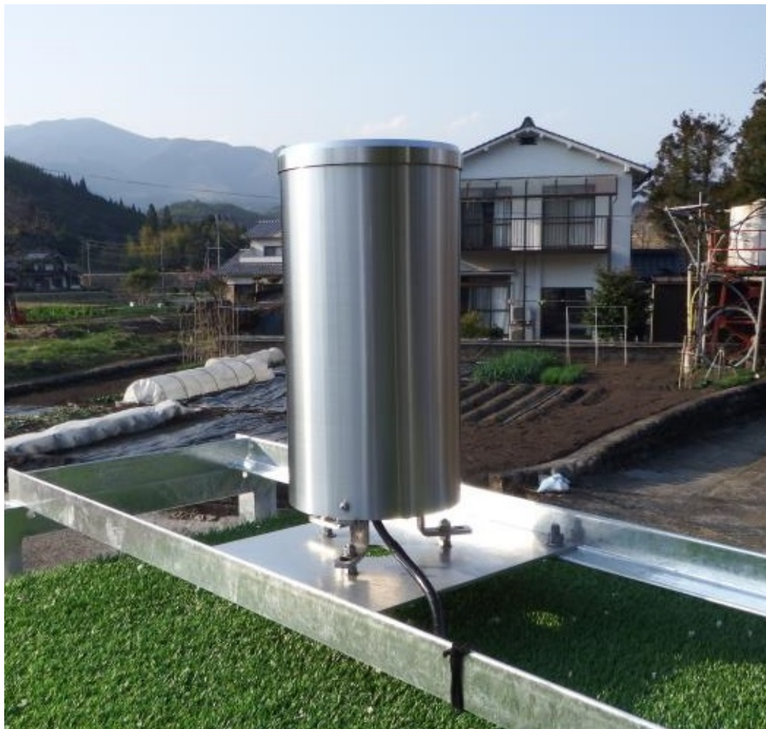
雨量計受水部
