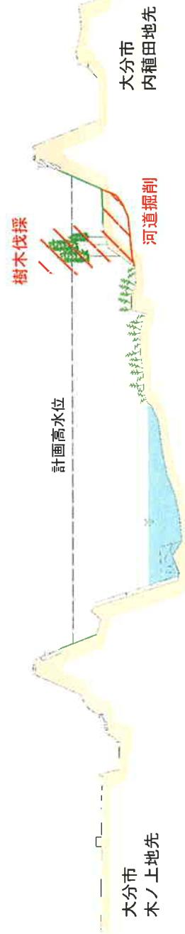
河道内の樹木を伐採するとともに、河道内の河積不足の要因となつていて堆積土砂を掘削します。なお、掘削にあたっては、生物の多様な生息・生育環境に配慮して、水辺などの良好な自然環境に配慮した整備に努めます。
