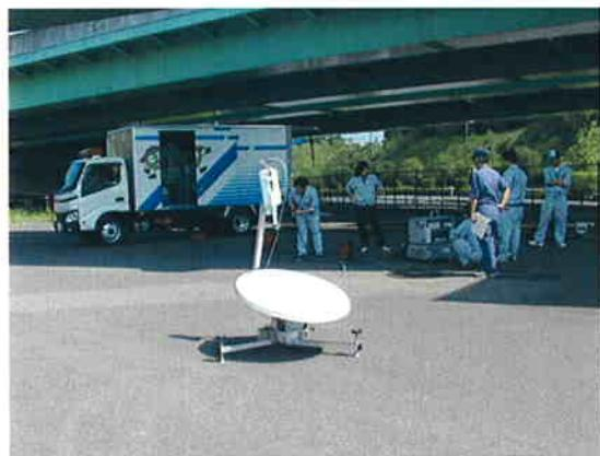
写真4.3.10 衛星小型画像伝送装置
