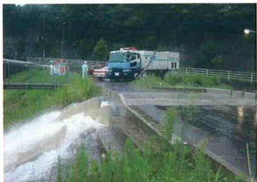
写真 4.3.11 緊急内水対策車
