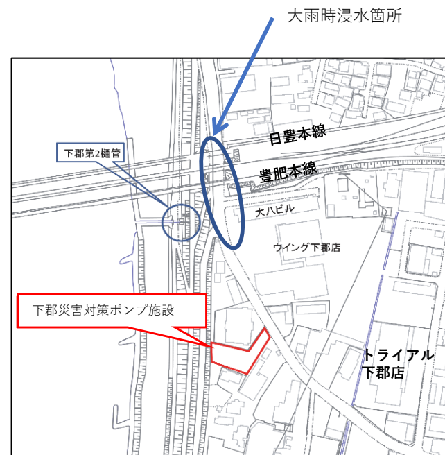
下郡地区（排水能力 1 \text{ m}^3/\text{秒} ）
