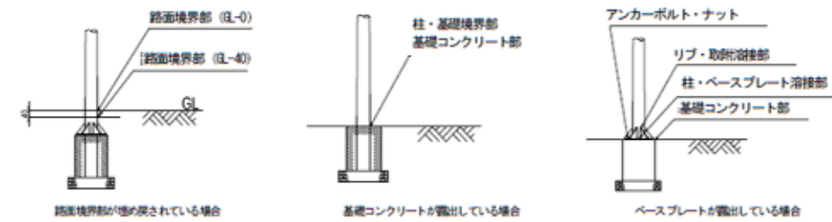
付図-1-1 主な点検箇所（支柱基部）
