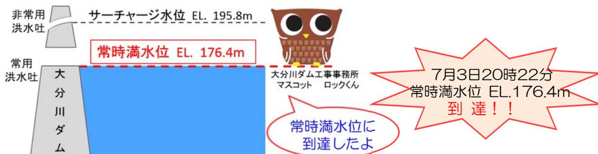
今後、6/11～10/20の期間、洪水発生時には常時満水位 EL.176.4mからサーチャージ水位 EL.195.8m までの 19.4m の水位幅で洪水処理を行います。
