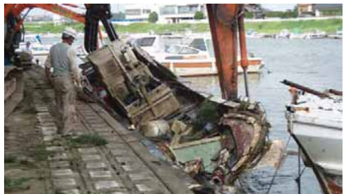
引き上げ途中でオイル漏れが見られたため中和剤を散布しながら作業を実施
