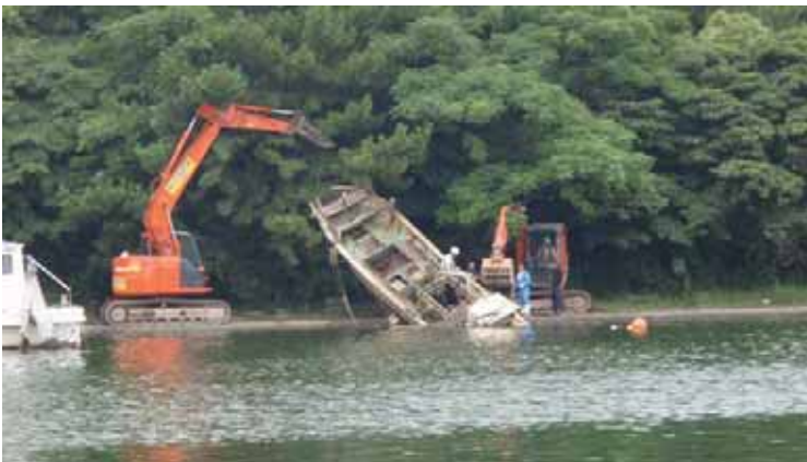
引き上げ途中でオイル漏れが見られたため中和剤を散布しながら作業を実施
