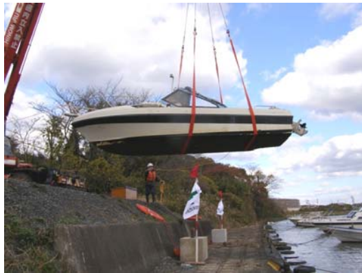
係留された船舶をつり上げ、撤去
