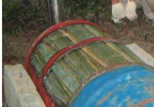
竹がキッチリと詰められた釜
