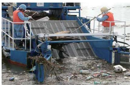
← 下流に流れ着いたゴミは塵芥収集船（クワガタ号）で収集されます
