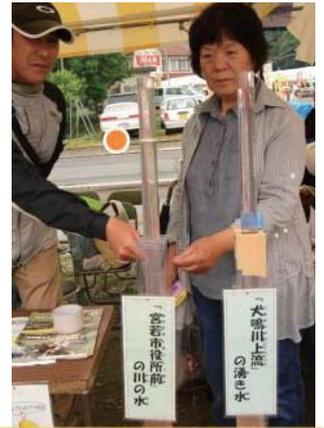
透視度計による水の透明度の比較
