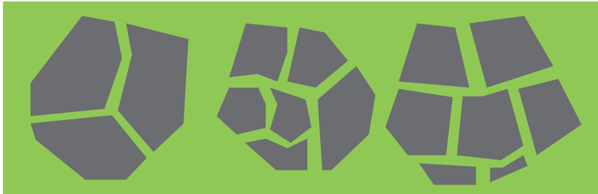
割った鉄平石を数個つなげて、クラック（隙間）の入った様々な形のかたまりを形成します
