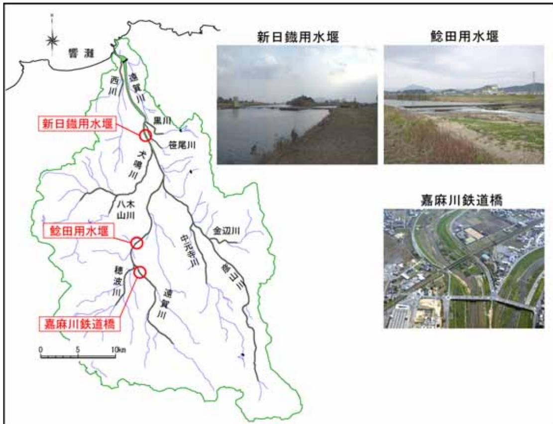
図2.1.2 主な洪水流下阻害の横断工作物
