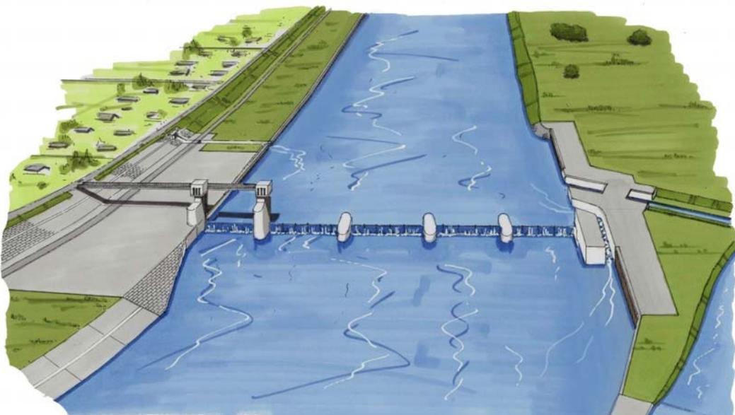
左の図は現在改築中の中間堰の完成イメージ図です。今後、各設備の詳細な仕様、設置位置、デザイン等に変更が生じる場合があります。
