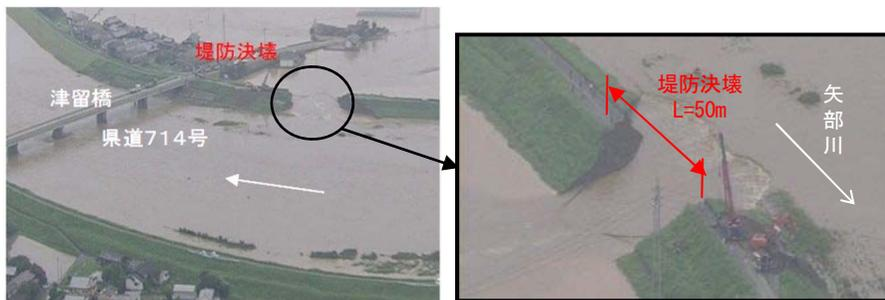
平成24年7月九州北部豪雨に伴う出水により、矢部川水系矢部川およびその派川沖端川で堤防が決壊し被害が発生した。
