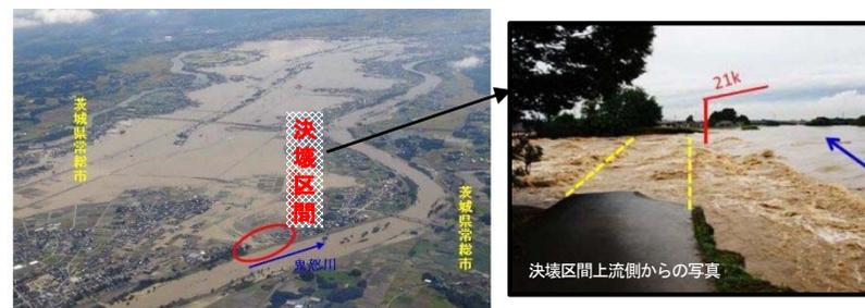
平成27年9月関東・東北豪雨により、利根川水系鬼怒川で堤防が決壊し、氾濫等による被害が発生した。**越水により川裏側の洗堀、崩壊が継続**したことで、堤防決壊に至ったと考えられている。
