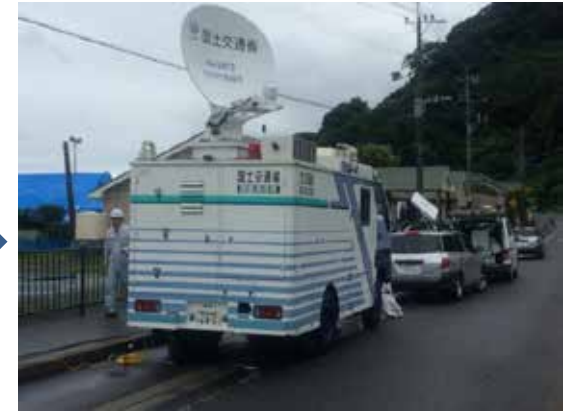
衛星通信車で災害対策本部や 垂水市市長室に映像を配信
