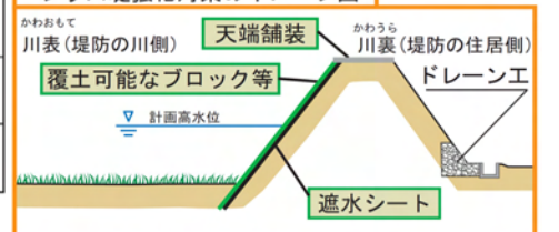
シラス堤強化対策のイメージ図
