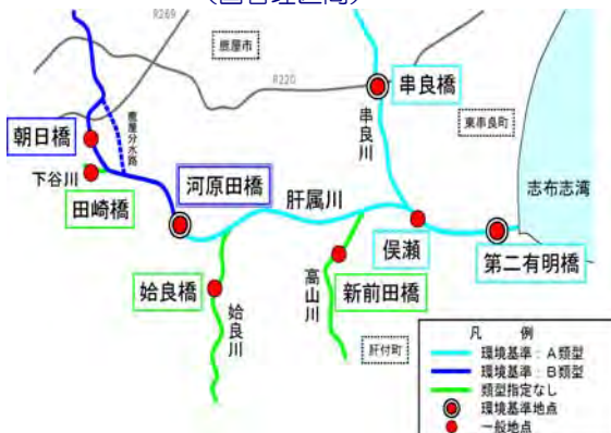
肝属川の環境基準地点と水質類型指定状況図 (国管理区間)
