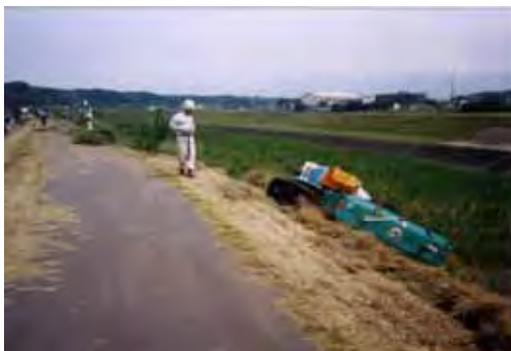
大型機械の遠隔操作による堤防除草
