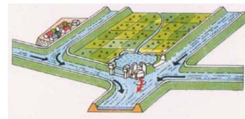
② 中小洪水の時は、遊水地内の水をポンプで吐き出し、浸水させない
