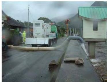
写真 2.1.3 排水ポンプ車による内水排除
