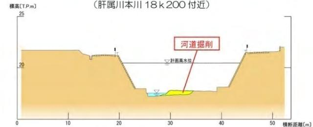
図 4.2.8 洪水対策イメージ図
