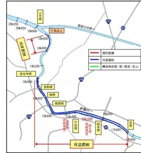
図 4.2.6 洪水対策箇所位置図
