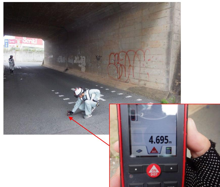
写真2.2.1-4 デジタル測距による形状確認の事例 39
