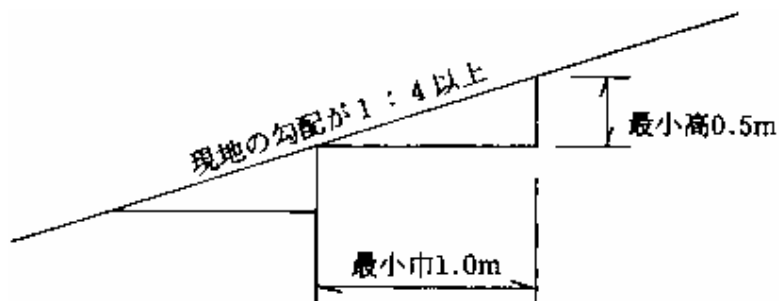
図2-1 盛土基礎地盤の段切
