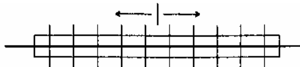
図 4 - 1 ボルト締付け順序
