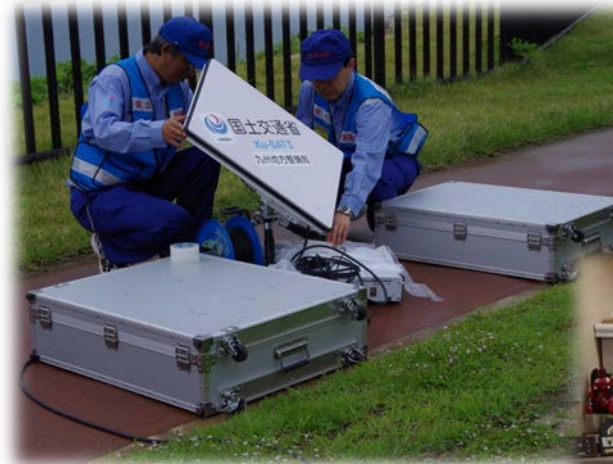
▲Ku-SAT(衛星小型画像伝送装置)カメラ映像をリアルタイムに配信
