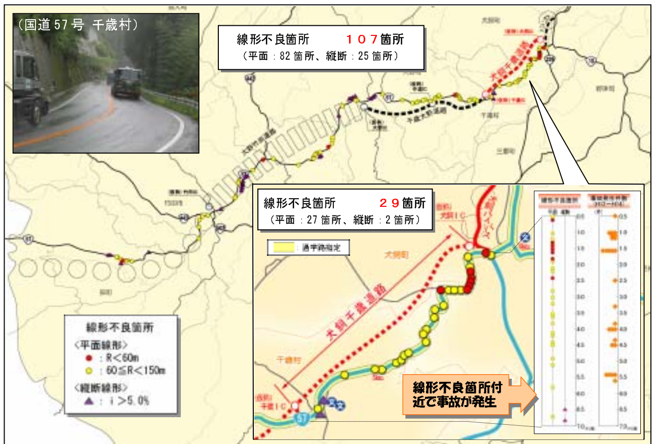
■ 国道 57 号の線形不良箇所
