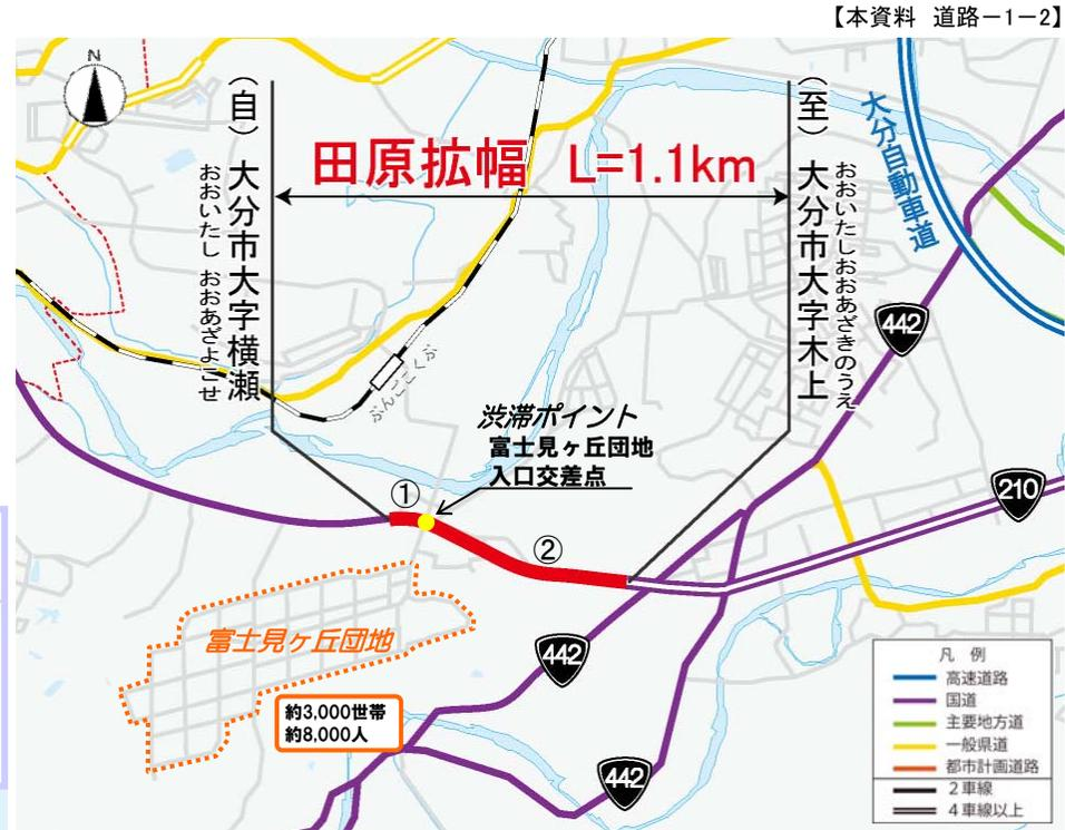
▲田原拡幅の概要図
