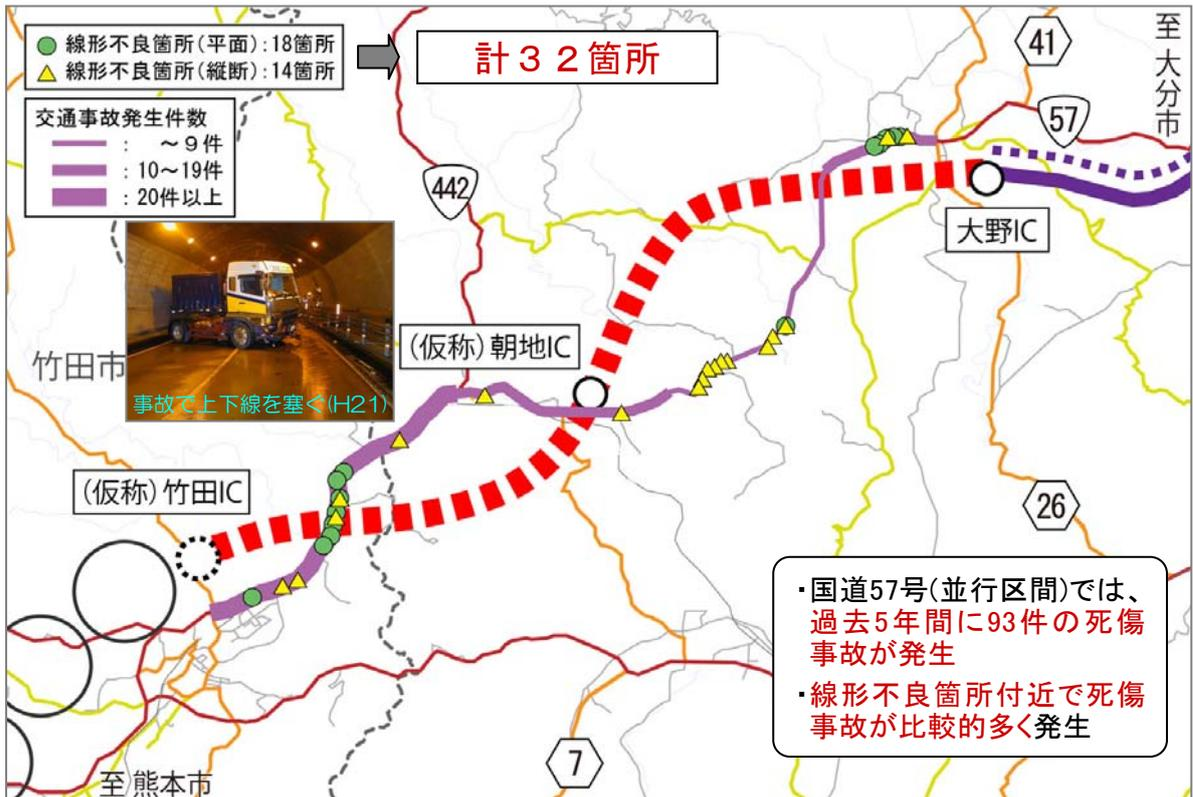
※線形不良箇所 【平面】：曲率半径150m未満、【縦断】勾配5%以上(平面・縦断ともに設計速度60km基準)
