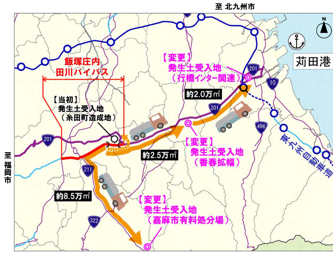
▲発生土搬出場所の見直し
