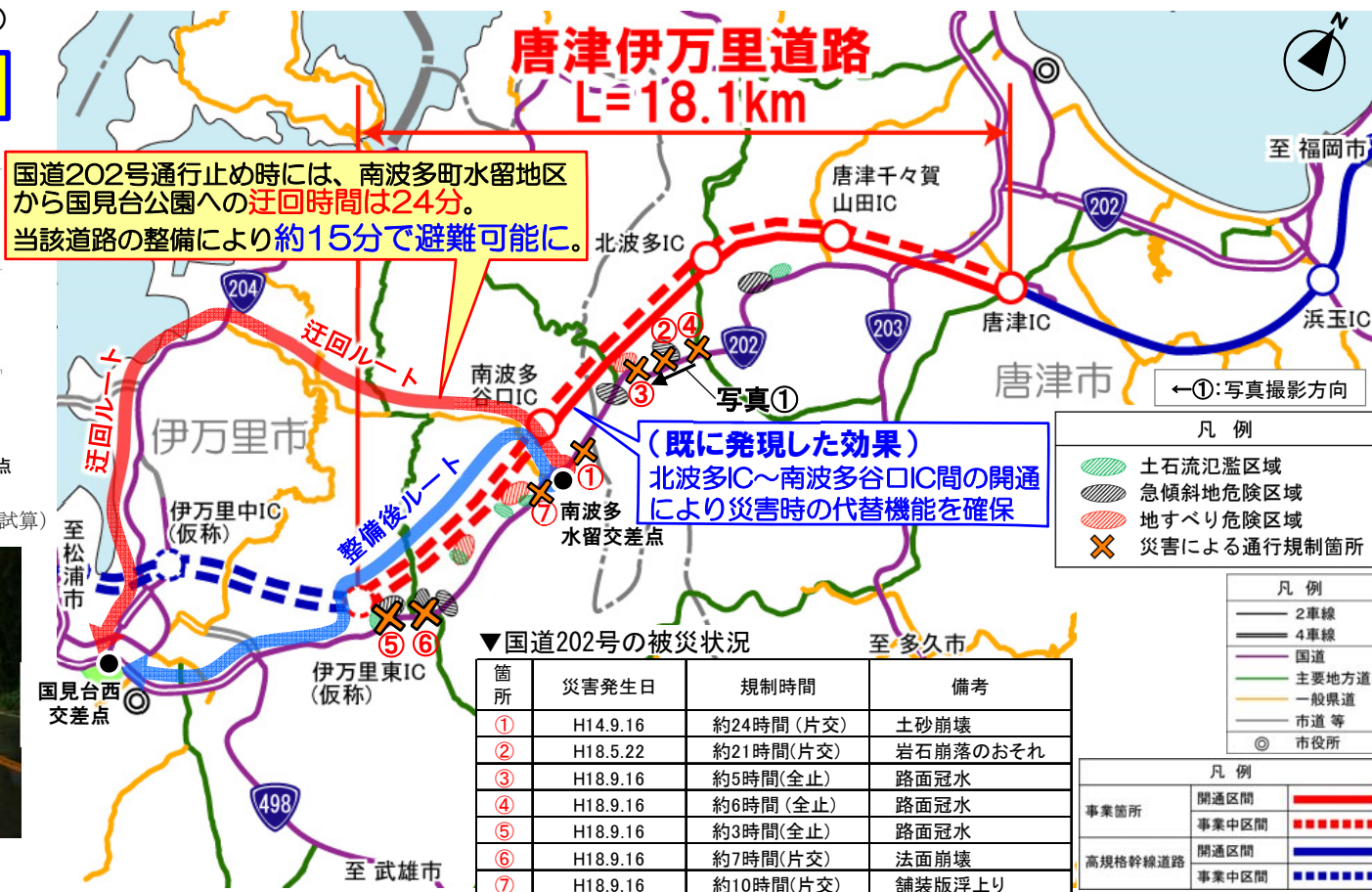
■国道202号の土砂災害、路面冠水などによる通行規制箇所及び迂回ルート
