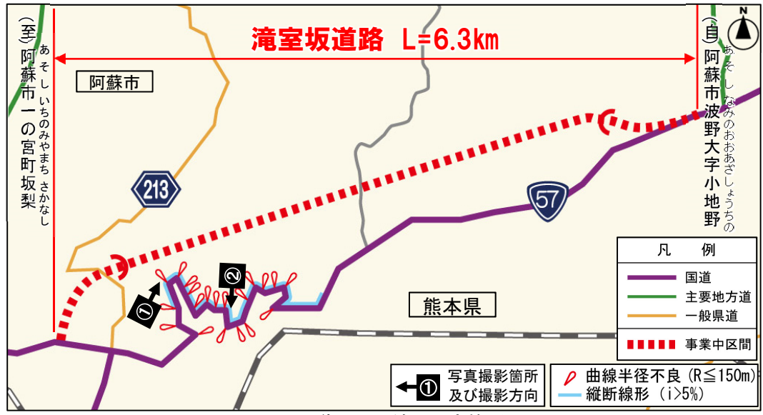
▲ 国道57号の線形不良箇所
