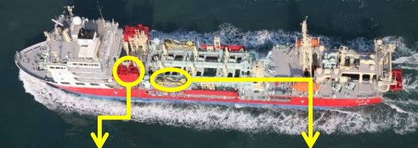
【海翔丸の油回収機能】 油回収器装備位置(両舷に装備)
